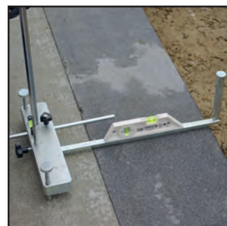
Der Anlegefix garantiert schnelles und maßgenaues Anlegen der Mörtelausgleichsschicht auf Keller- und Geschoßdecke.
