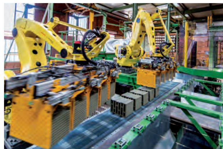
Die Roboter greifen die noch nassen Ziegel-Formlinge ab und setzen sie anschließend direkt auf Trocknerpaletten.
