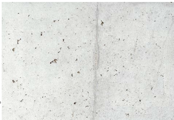
Beton mit gefügedichter Oberfläche
