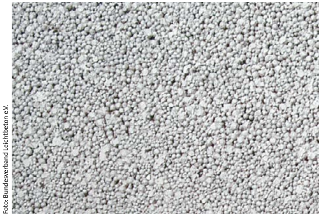
Beton mit haufwerksporiger Oberfläche
