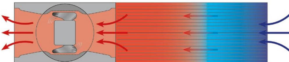
Die komplette Lüftereinheit wird um 180° nach außen gedreht. Die optimierte Strömungsrichtung wird beibehalten. Die Vermeidung des ständigen Änderns der Drehrichtung durch Stoppen und Starten des Lüfterrades sorgt für mehr Laufruhe und erhöht gleichzeitig die Lebensdauer der Komponenten.
