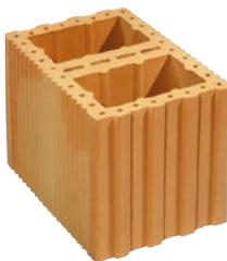
Der PFZ mit 2 Kammern macht Anfänger überflüssig – ein Schnitt durch die Lochreihe im Mittelsteg schafft exakt zwei halbe Ziegel. Ecken, Tür- und Fensterrahmen sowie Aufzugsschächte können so noch leichter hergestellt werden als bisher.
