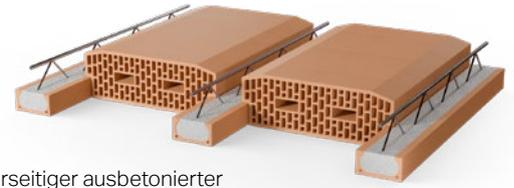
Ziegel-Einhängedecken bestehen aus raumlang vorgefertigten bewehrten Trägern mit unterseitiger ausbetonierter Ziegelschale. Zwischen die Träger werden auf der Baustelle spezielle Deckenziegel eingehängt. Durch das geringe Gewicht der Bauteile und die einfache Verlegung ergeben sich für das System im Bereich Altbausanierung und Eigenleistung vielfältige Vorteile und Einsparpotenziale.
