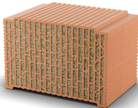
40 Prozent mehr Stabilität sind das Ergebnis jahrelanger Forschung und Entwicklung: Der WS09 CORISO PLUS ist mit einer charakteristischen Mauerwerksdruckfestigkeit von  $f_k$  5,9 MN/m<sup>2</sup> der mit deutlichem Abstand stabilste Ziegel. Er kann einer Belastung von bis zu 590 Tonnen auf einen Quadratmeter Wand standhalten.
