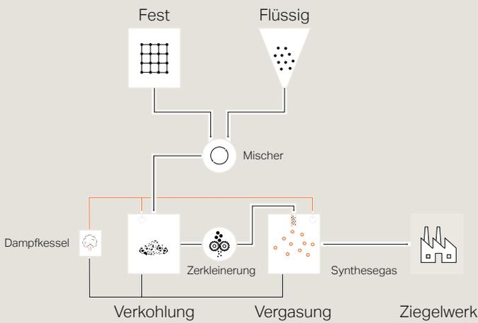
Dank der hoch innovativen Technologie von blueFLUX entsteht aus den Reststoffen Klärschlamm und Holz ein Synthesegas mit hohem Wasserstoffanteil, das mittelfristig fossiles Erdgas am Standort Dachau künftig nahezu komplett ersetzen soll.
