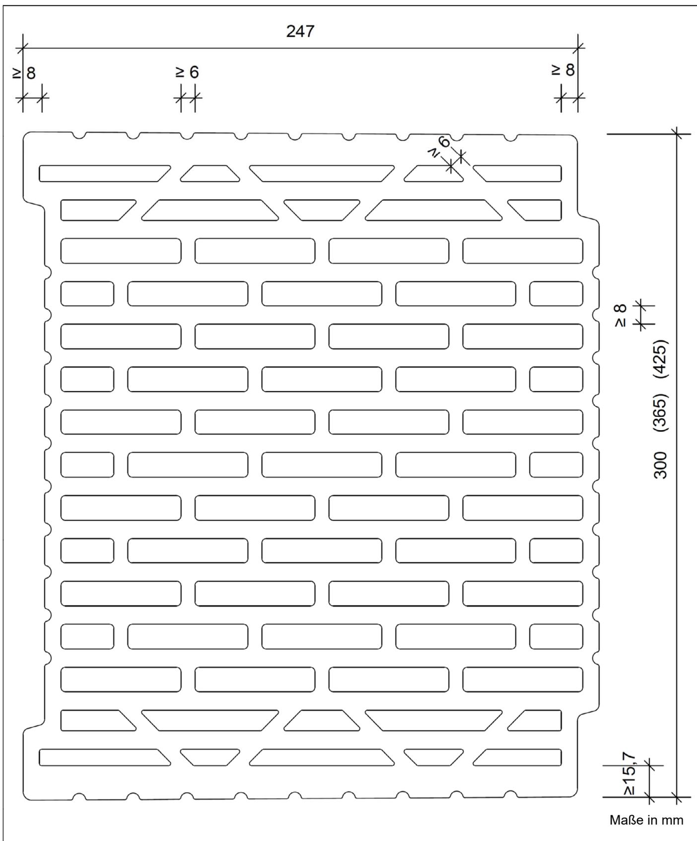
Mauerwerk aus UNIPOR WS09 SILVACOR Planziegeln im Dünnbettverfahren mit gedeckelter Lagerfuge
