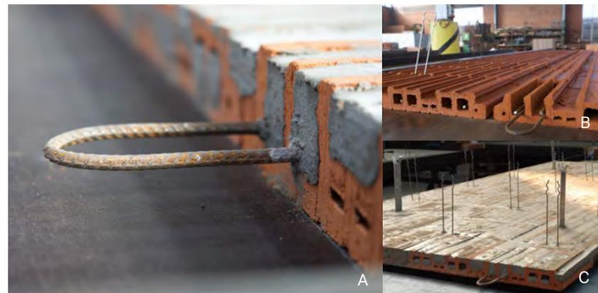
Abb. 17: Montageglaschen zum Heben in die Schalung (A). Befestigungspunkte: Doppelnadeln, Montageglaschen und V4a-Anker werden einbetoniert (B und C).
