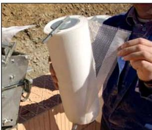
Ist die Laufflänge des Vlieses beinahe zu Ende, wird eine neue Rolle aufgesetzt und mit dem Rest der Vorgängerrolle verklebt (doppelseitiges Klebeband ist nicht im Lieferumfang).
