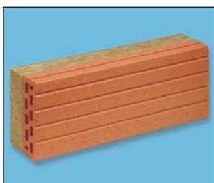
Deckenrandschale mit werksseitig aufgeklebter Isolierung, einer speziellen, hydrophobierten Mineralwolle (WLG: 035; U-Wert: 0,41 W/m²K), gegen Schalungsdruck.
