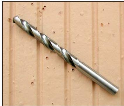
Tipp: Angeschliffene Hartmetallbohrer (wie Stahlbohrer) verwenden - diese bohren schneller!
