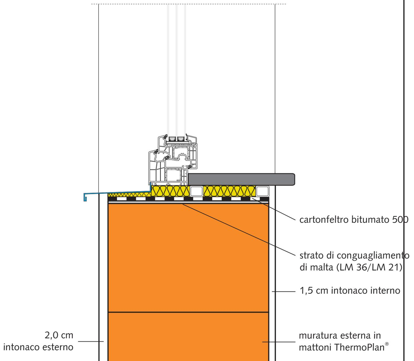
I parapetti delle finestre sono particolarmente a rischio di impregnarsi di umidità durante il tempo di costruzione. Per evitare lunghi tempi di asciugatura o addirittura danni da gelo, bisogna impedire con misure adeguate il formarsi di umidità a causa dell'acqua di superficie.
