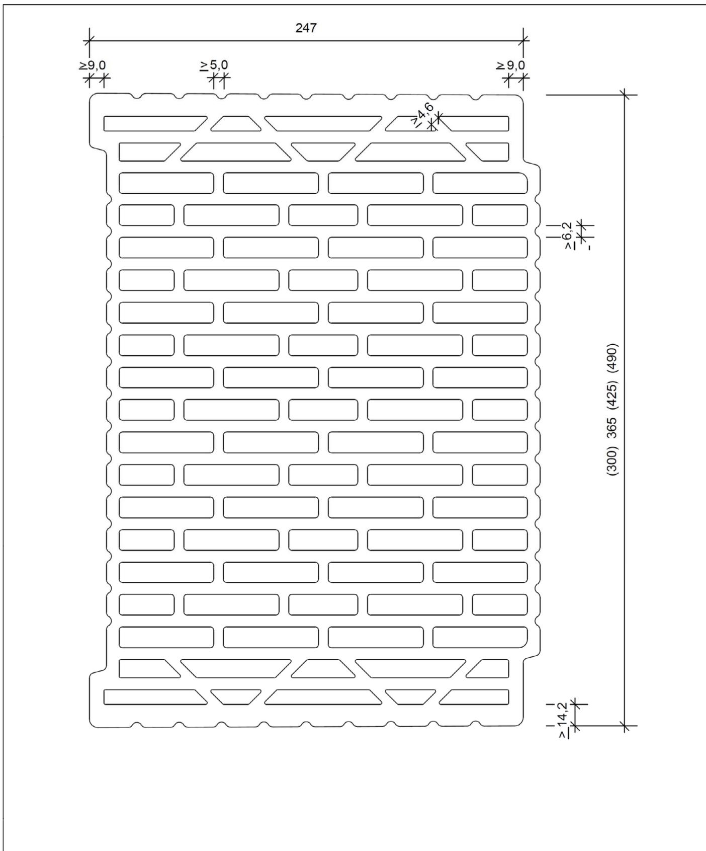
Mauerwerk aus Planhochlochziegeln UNIPOR WS09 CORISO PLUS
