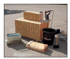
In cantiere s'impiega: rullo VD per malta, un secchio da 30 litri, mescolatore con miscelatore, Anlegefix, stadia in alluminio, malta isolante LM 21, martello di gomma.
