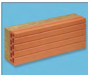
Cordolo perimetrale in sistema DeRa plus preaccoppiato con isolamento termico in lana di roccia (classe di conducibilità: 035; valore di U: 0,41 W/m<sup>2</sup>K).
